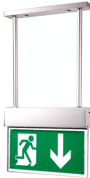
Einseitige/Beidseitige Einzelbatterie-Rettungszeichenleuchte mit komplettem Piktogrammsatz zur Selbstmontage (links/rechts/unten). Lebensdauer der LED > 50.000 Stunden. Alle vorgeschriebenen Funktionsprüfungen werden vollautomatisch getätigt und durch eine LED-Anzeige dokumentiert. Lieferung erfolgt einschließlich Pendelmontageset.
