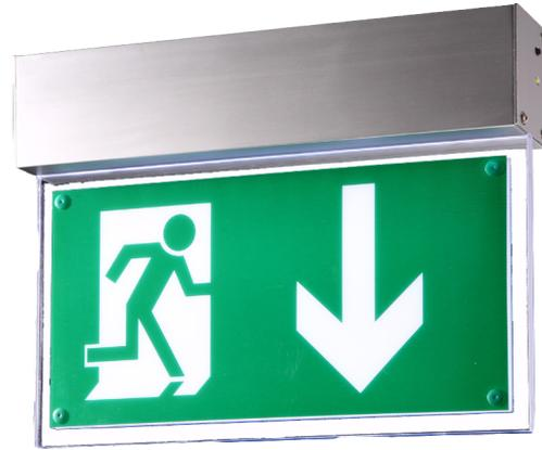
Einseitige Einzelbatterie-Rettungszeichenleuchte mit komplettem Piktogrammsatz zur Selbstmontage (links/rechts/unten). Lebensdauer der LED > 50.000 Stunden. Alle vorgeschriebenen Funktionsprüfungen werden vollautomatisch getätigt und durch eine LED-Anzeige dokumentiert.
