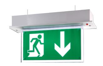
Einseitige/Beidseitige Einzelbatterie-Rettungszeichenleuchte mit komplettem Piktogrammsatz zur Selbstmontage (links/rechts/unten). Lebensdauer der LED > 50.000 Stunden. Alle vorgeschriebenen Funktionsprüfungen werden vollautomatisch getätigt und durch eine LED-Anzeige dokumentiert.
