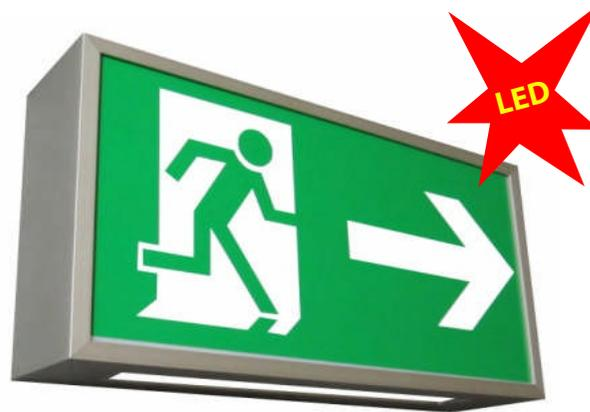
Einzelbatterie-Rettungszeichenleuchte mit Aluminium-Gehäuse. Zusätzlicher Lichtaustritt auf der Unterseite. Ausführungen als Decken-, Ketten-, Pendel- oder Wandauslegermontage. Dauer- oder Bereitschaftslicht. Alle vorgeschriebenen Funktionsprüfungen werden vollautomatisch getätigt und durch eine LED-Anzeige dokumentiert. Pro Leuchte sind zwei Piktogrammscheiben erforderlich.
