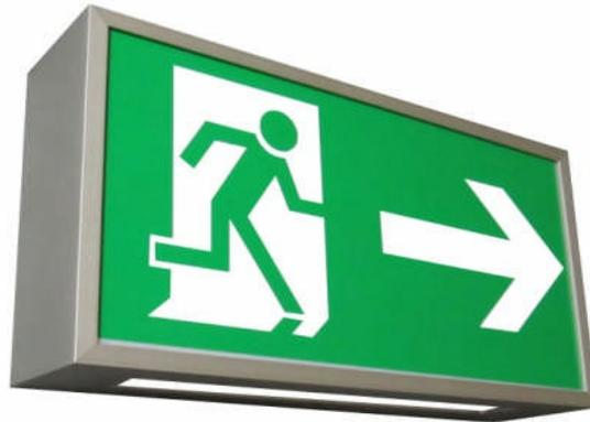
Einzelbatterie-Rettungszeichenleuchte mit Aluminium-Gehäuse. Zusätzlicher Lichtaustritt auf der Unterseite. Ausführung als Wandmontage. Dauer- oder Bereitschaftslicht. Alle vorgeschriebenen Funktionsprüfungen werden vollautomatisch getätigt und durch eine LED-Anzeige dokumentiert. Pro Leuchte ist eine Piktogrammscheibe erforderlich.
